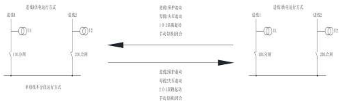
图 3-5 单母方式下运行状态转换
